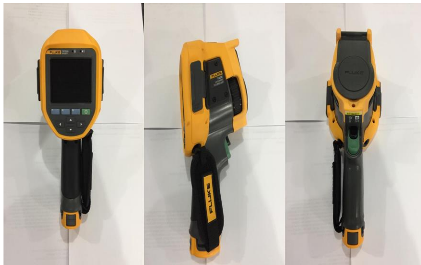
Figura 7 – Câmera térmica utilizada para analisar variação de temperatura nas fachadas. Fonte: Autor (2019).
